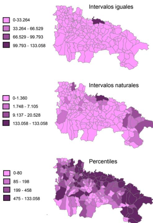
Figura 9.4: Comparación entre distintos esquemas para la creación de intervalos de clase.
