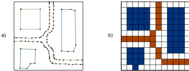
Figura 4.6: Comparación entre los esquemas del modelo de representación vectorial (a) y ráster (b).
